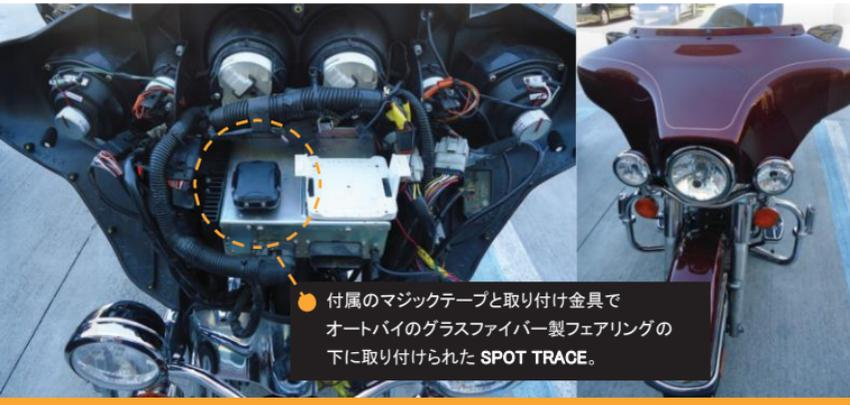
● 付属のマジックテープと取り付け金具でオートバイのグラスファイバー製フェアリングの下に取り付けられた SPOT TRACE。
